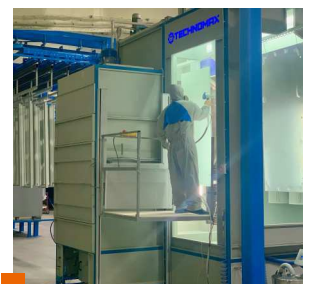
Атмосферостойкая порошковая краска и обезжиривание фосфатирующим составом Повышенная антикоррозионная стойкость
